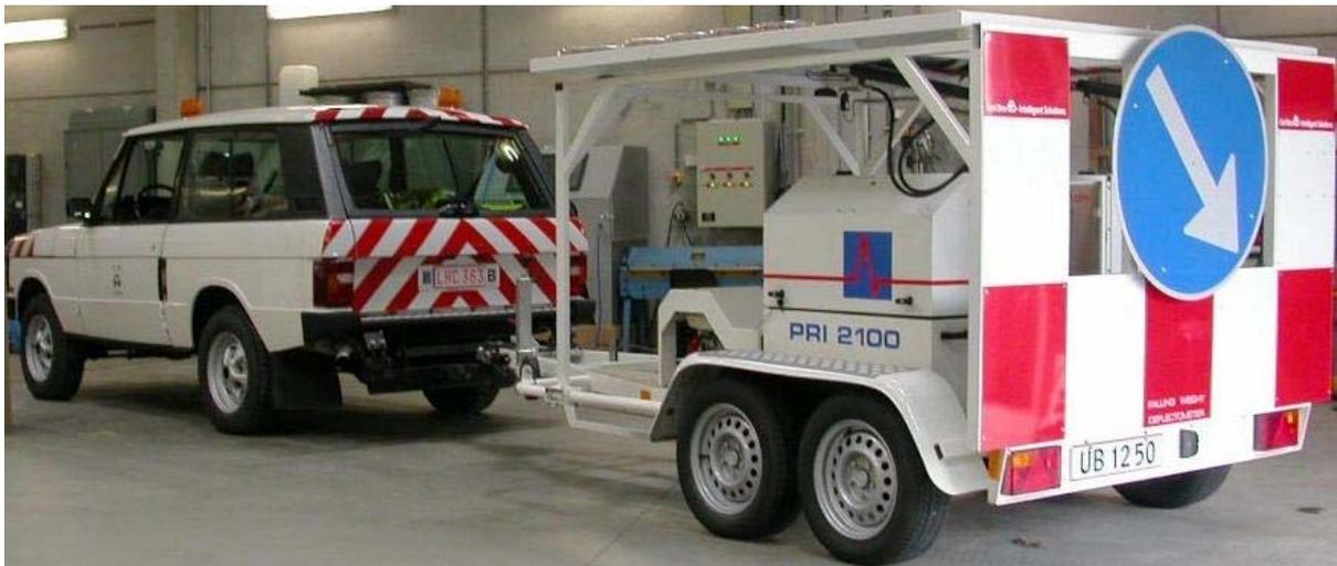
Le FWD est utilisé sur chaussées flexibles (souples), rigides et mixtes ou pour leur fondation.
