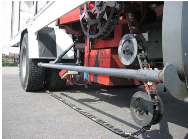
Le curviamètre est utilisé uniquement sur chaussées souples (bitumineuses) ou semi-souples.
